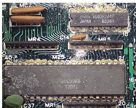
Рис. 1. Коррозия разрушает оборудование в металлических шкафах управления
